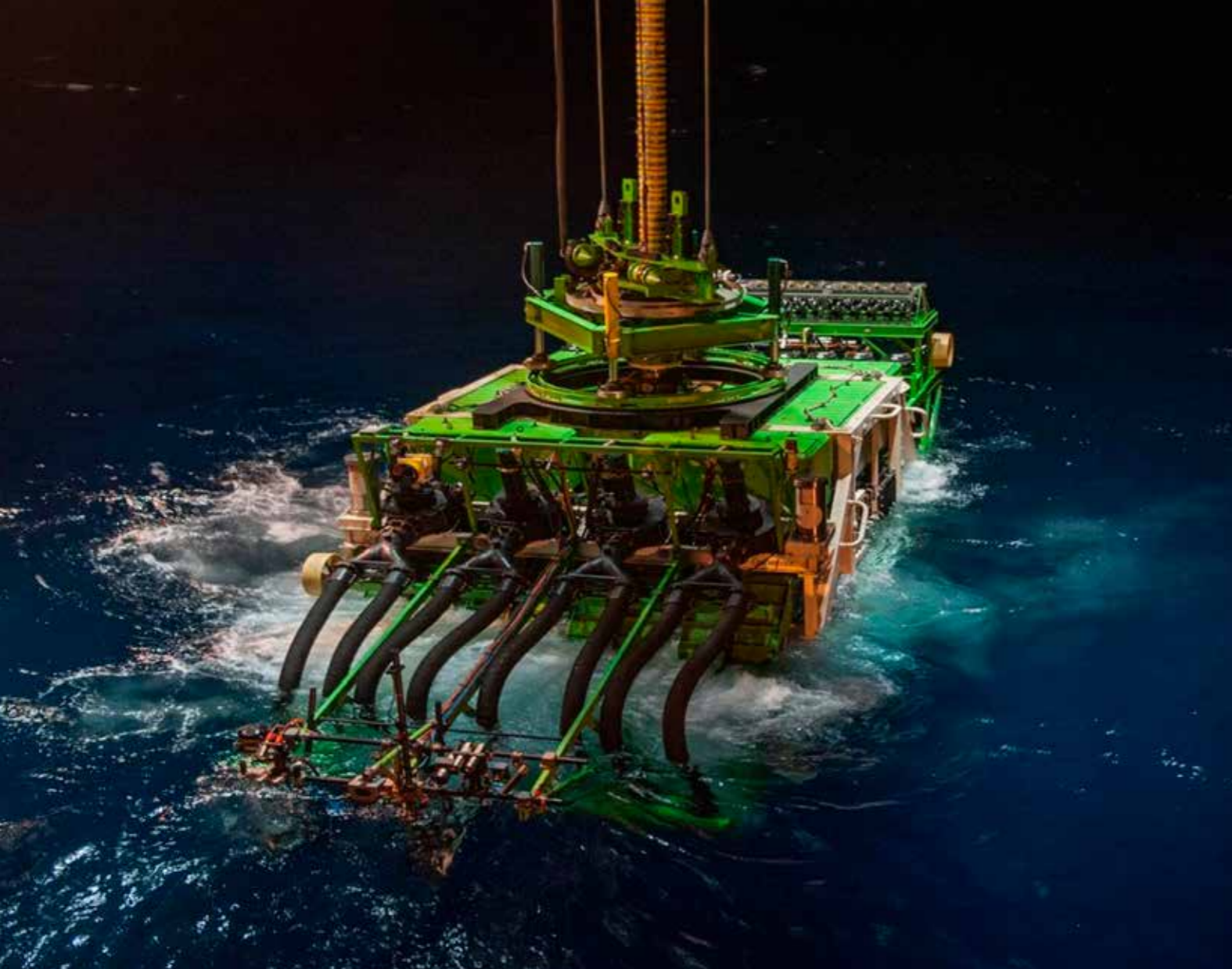
Diepzeerobot Patania wordt gebruikt om mangaanknollen op de oceaانبodem te verzamelen. © DEME
